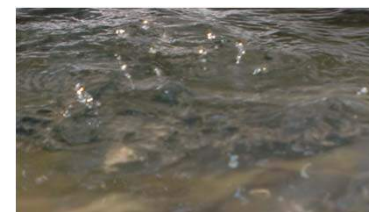
液滴が水面から飛散するスプラッシュ現象 (常温市水、脱気なし、1200W、28KHz)
