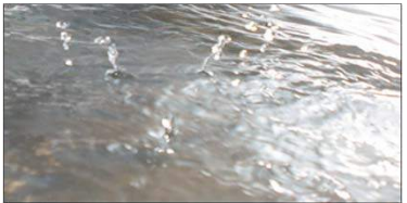
液滴が水面から飛散するスプラッシュ現象 (常温水、脱気なし、1200W、28kHz)
